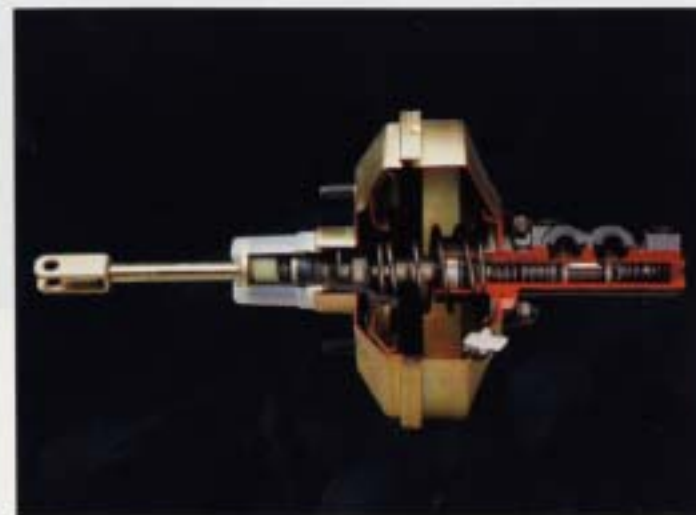
Bromskraftförstärkare. Med bromskraftförstärkaren bromsar man mjukt och säkert med lågt pedaltryck. Det undertryck som uppstår från motorn i insugningsröret, utnyttjas genom bromskraftförstärkaren till att stödja pedalkraften.
