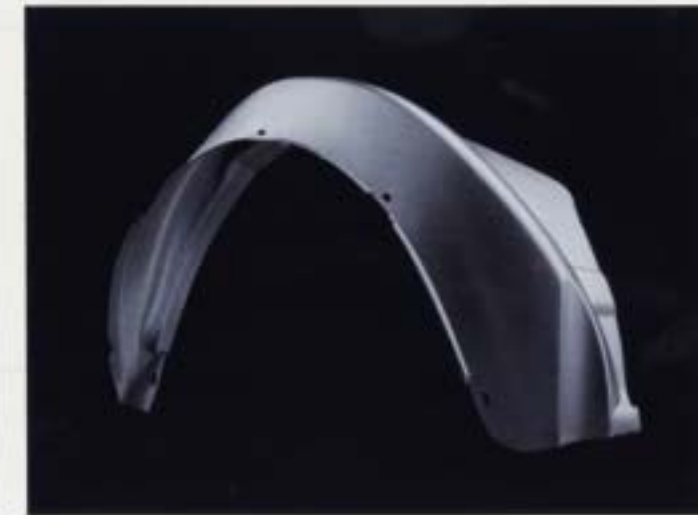
Delar av plast och underredsbeklädnad. De delar som är mest utsatta för stenskott, som tex de främre hjulhusen, är klädda i plast. Skarvar, fogar och fälsar tätas. Slutligen förses hela det område av bottenplattan som är mest utsatt för stenskott med ett tjockt, hållbart och elastiskt skikt av PVC-material.
