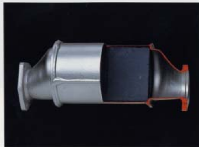
Katalysator. Samtliga Golf är utrustade med katalysator. Katalysatorn startar och påskyndar en kemisk reaktion som omvandlar de giftiga beståndsdelarna till mindre farliga ämnen. Katalysatorn är särskilt effektiv tillsammans med lambda-inställningen och reducerar de giftiga beståndsdelarna i avgaserna till ett minimum.
