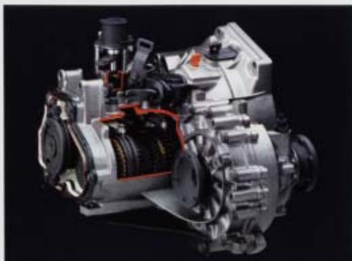
Femväxlad växellåda. Genom varvtalsminskningen i den femväxlade växellådan reduceras både ljudnivå och bränsleåtgång. Förutom att ett lägre varvtal innebär mindre försilning, är drivaxeln särskilt robust lagrad med koniska rullager som bättre tål påfrestningar och ger längre livslängd.
