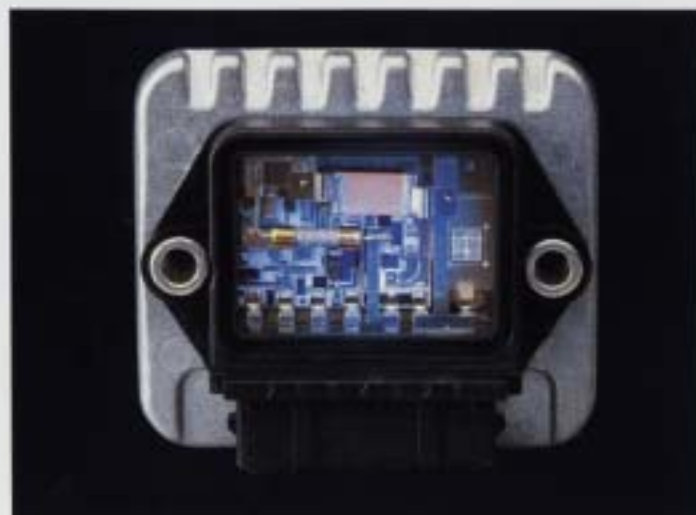
Brytaren i det elektroniska tändsystemet. Med transistorstyrningen får man en trygg start även under ogynnsamma väderleksförhållanden. Tändsystemet arbetar kontaktlöst och behöver därför, bortsett från att long-life tändstiftens byts var 3000:e mil, inte någon skötsel. Den kraftiga tändnistan sørjer för en säker förbränning och därmed ett bra utnyttjande av bränsle-luftblandningen.
