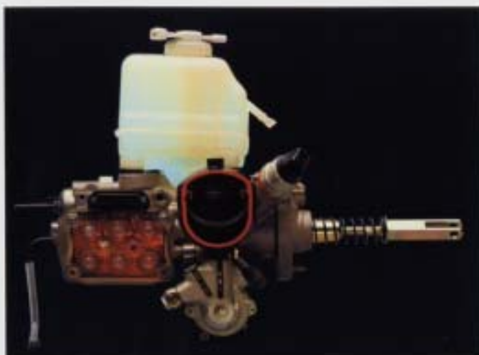
ABS-bromsar. Genom separata elektromagnetiska avkännare på alla fyra hjulen ser Volkswagens avancerade lösning fria ABS-bromssystem till att du alltid får maximal bromseffekt på varje hjul oavsett underlag och samtidigt bibehåller styrförmåga.
