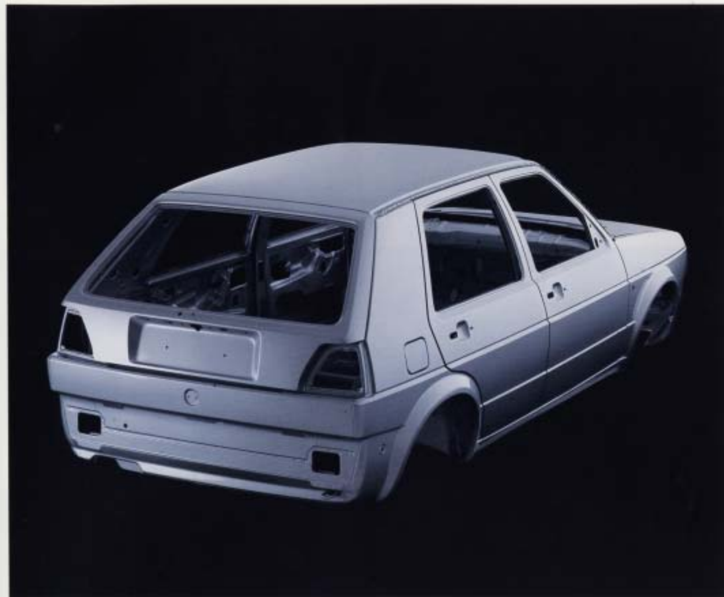
Korrosionsskyddad kaross. De delar av karossen som är särskilt utsatta för rost, som tex insidan av motorhuven, är tillverkad i förzinkad plåt. Alla de nedre hållheterna i karosseriet, dörrarna och bakluckans bakre del behandlas med helvax som sprutas in i en effektiv helautomatisk process. På så sätt når vaxet även de mest avlägsna skymslen och vrår.
