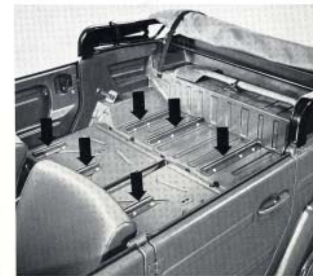
Ladefläche mit C-Schienen zur Gerätebefestigung Load surface with C-profile rails for securing equipment Plancher de chargement avec tringles en C pour la fixation des outils
